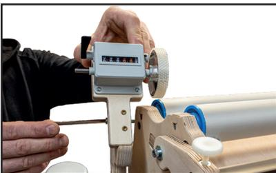
10. Rulerhebel und Counter mit Zylinderschrauben anbringen.
