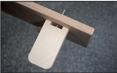
7. Die Rollenhalter werden in die vorgefrästen Zapfenlöcher hineingesteckt und mit der Senkkopfschraube in das linke Seitenteil verschraubt.
