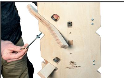
8. Die Kipphebel einsetzen und mit den Zylinderschrauben fixieren.
