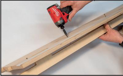
6. Die Stützstrebe unter die Schneideplatte setzen und zwischen den Seiten verschrauben.
