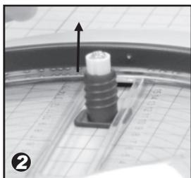
Entnehme das weiße Gehäuse vorsichtig aus der Halterung und wechsel das Messer aus.
