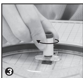
Setze dannach das weiße Gehäuse mit Messer und der Feder wieder in den Positionierer und schraube den Deckel wieder auf.
