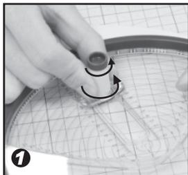
Entsperr zuerst den **Positionierer MIT dem Regler gleichzeitig.**
