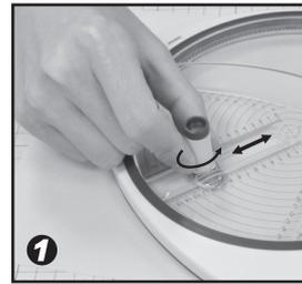
Entsperr den Positionierer mit einer Linksdrehung um den gewünschten Radius einzustellen.
