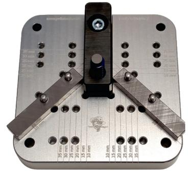
Mit einem Modul sind drei verschiedene Einstellvarianten möglich. Die Leisten können durch einfaches Umstecken umpositioniert werden und durch Wenden der Leisten sind unterschiedliche Maße erreichbar.
