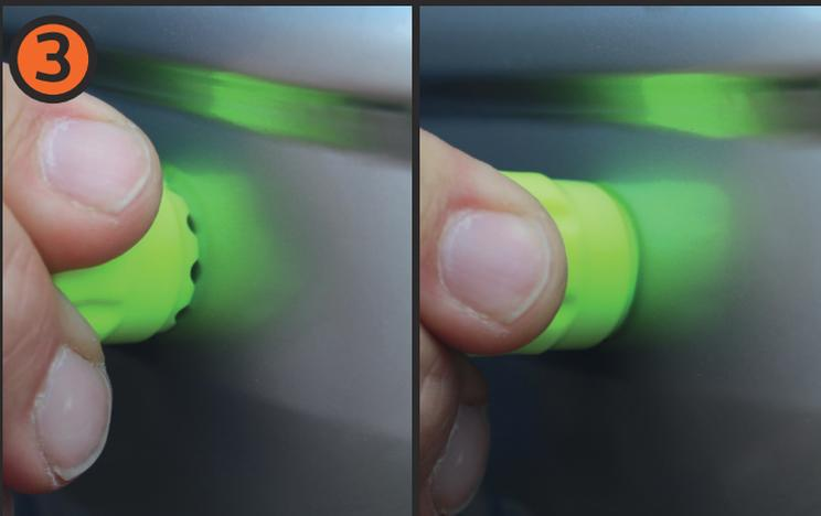
SensorCut ansetzen und mit einer Drehbewegung PDC-Sensor ausschneiden
