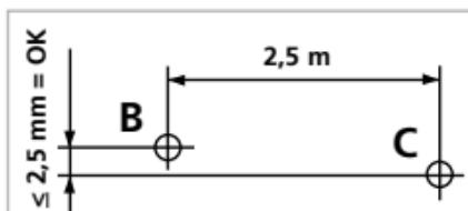
Sprawdzić, czy punkty B i C leżą w poziomie (tolerancia  $\pm 2$  mm). Pomiar powtórzyć przesuwając laser w lewo.
