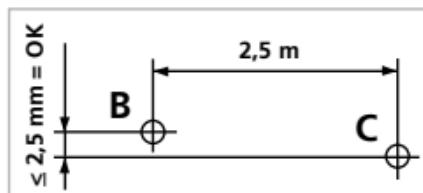
de wand markeren, laserkruis ca. 2,5 meter naar rechts draaien en punt C markeren. Controleer nu of de waterpaslijn van punt C op gelijke hoogte ligt met punt B - met een tolerantie van max.  $\pm 2$  mm. Dezelfde controle kunt u tevens naar links uitvoeren.
