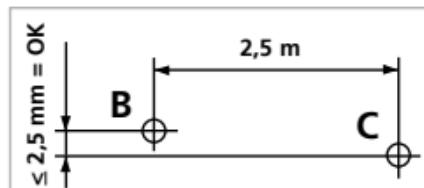
croisé d'env. 2,5 m. vers la droite et marquer le point C. Vérifiez si la ligne horizontale du point C se trouve à  $\pm 2$  mm à la même hauteur que le point B. Répétez l'opération en faisant pivoter vers la gauche.
