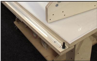
4. Die beiliegenden Laufschienen werden unter der Tischplatte angeschraubt. Schrauben sind nicht im Lieferumfang enthalten!
