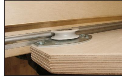
5. Den Appfix Racer in die Schienen einsetzen.
