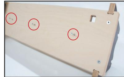
3. Die Grundplatte 2 und die Querstrebe 1 mit den Spaxschrauben 10 verbinden.
