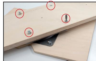
4. Den Drehbeschlag 4 unter der Grundplatte 2 mit den Senkschrauben 11 befestigen.
