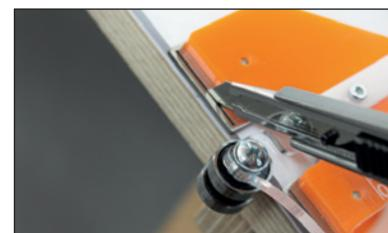
Setze das Messer in die Führung und fahre mit den Kugellagern entlang einer Außenkante.
