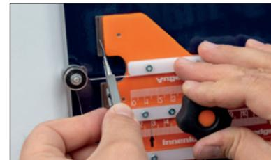
Setze das Messer in die Führung und fahre mit den Kugellagern entlang einer Innenkante.
